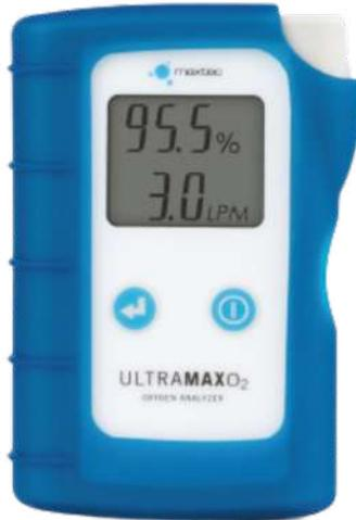
El analizador UltraMax O2 fue diseñado para verificar la concentración de oxígeno de un vistazo, incluido el flujo y la presión de salida de los concentradores de oxígeno. Su diseño avanzado proporciona un rendimiento y una fiabilidad de alto nivel.
